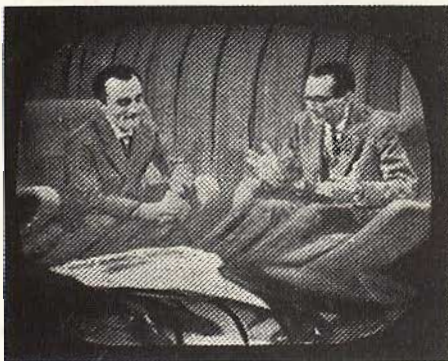
Fig. 4 - Anomalie di due immagini televisive dovute a disturbi provocati da tubi fluorescenti difettosi.
